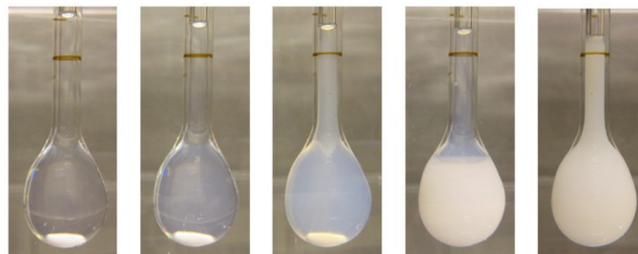
Fig. 温度がかわると透明な一相状態から二相に分離して、最後は液晶一相状態へ変化する様子
